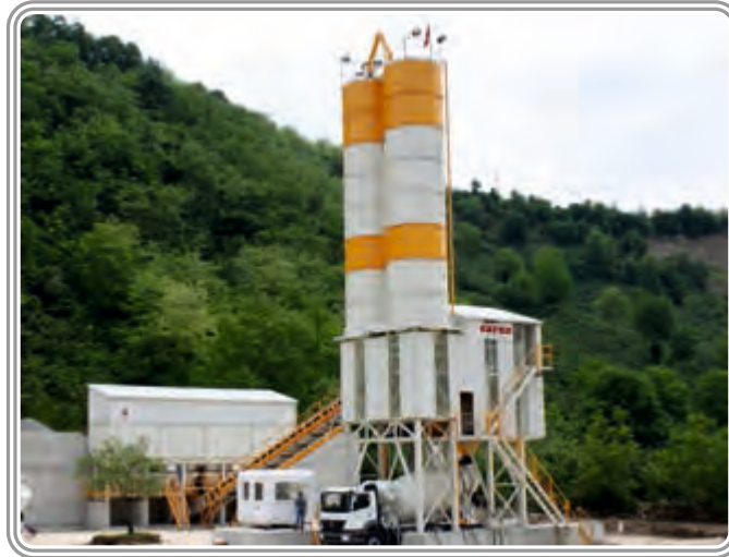
PINAR BETON YAPI ELEMANLARI İNŞAAT SANAYİ & TİCARET LTD. ŞTİ. 90 m 3 /saat YAŞ KARIŞIM BETON SANTRALİ
