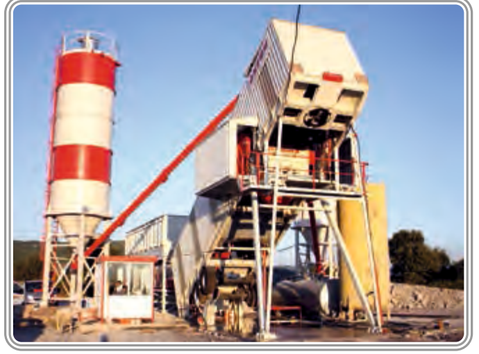
Faruk Duman Çanakkale Türkiye 90 m 3 /saat Yaş Karışım Hazır Beton Santrali Faruk Duman Hazır Beton Balıkesir / Gönen / Türkiye 70 m 3 /saat Yaş karışım Mobil Hazır Beton Santrali
