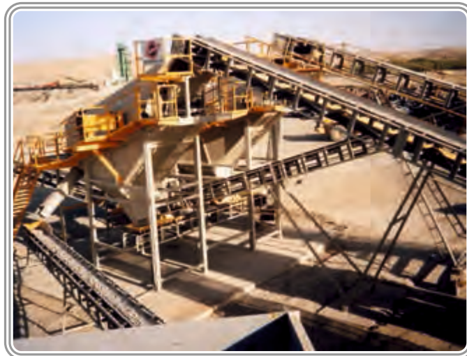
GÜLSAN / ŐUKUROVA ORTAK GİRİŐİMİ AFGANİSTAN / KANDAHAR 120 ton/saat DERE MALZEMESİ KIRMA ve ELEME TESİSİ
