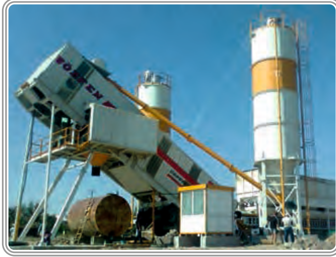
ENGİZLİ Otocam / KIRGIZİSTAN 70 m 3 /saat Yaş Karışım Mobil Hazır Beton Santrali
