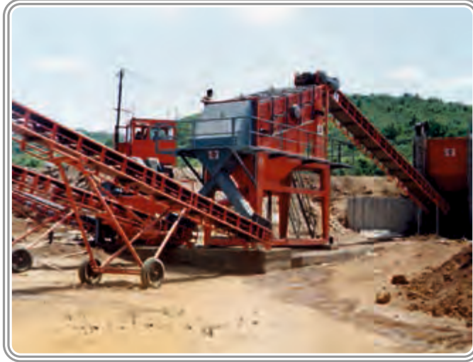
CANTAŐ MADEN İŐLETMELERİ 200 ton/saat Kum Yıkama Eleme tesisi
