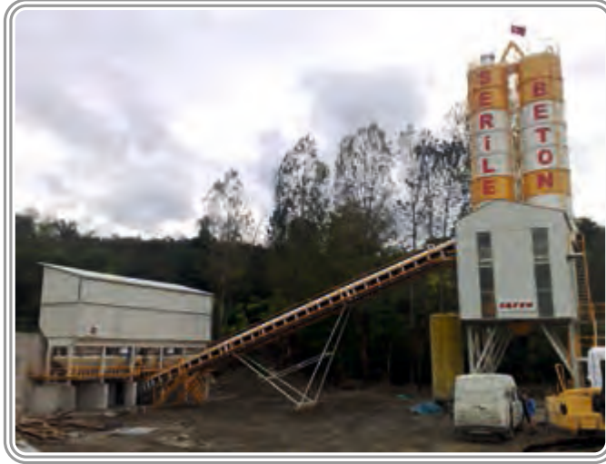
Seriler Beton Ordu / Fatsa Türkiye 90 m 3 /saat Yaő Karıőım Beton Santrali
