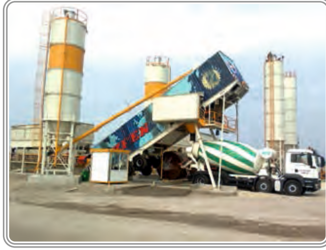
ONUR Taahhüt Tařımacılık ve Ticaret Limited Őirketi / MOLDOVYA 70 m 3 /saat Yař Karıřım Mobil Hazır Beton Santrali
