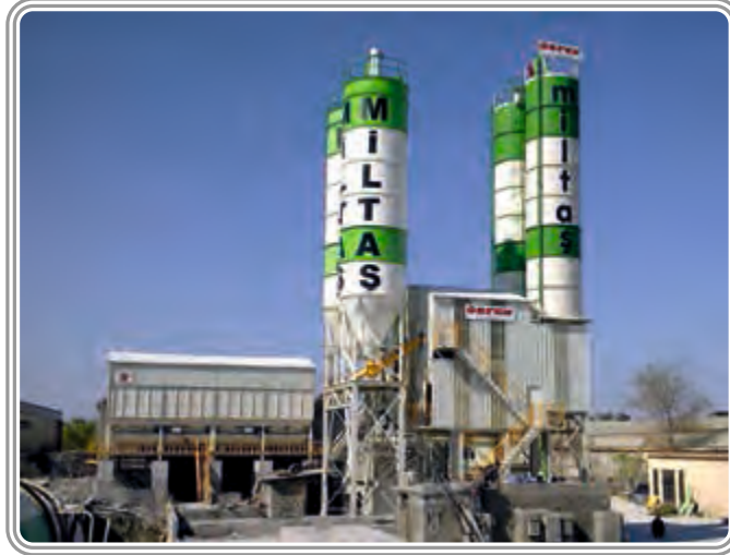
Miltaş Beton İstanbul / Samandıra Türkiye 120 m 3 /saat Yaş karışım hazır beton santrali
