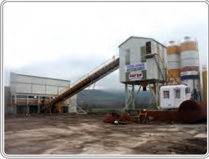
Faruk Duman Çanakkale Türkiye 90 m 3 /saat Yaş Karışım Hazır Beton Santrali Faruk Duman Hazır Beton Balıkesir / Gönen / Türkiye 70 m 3 /saat Yaş karışım Mobil Hazır Beton Santrali
