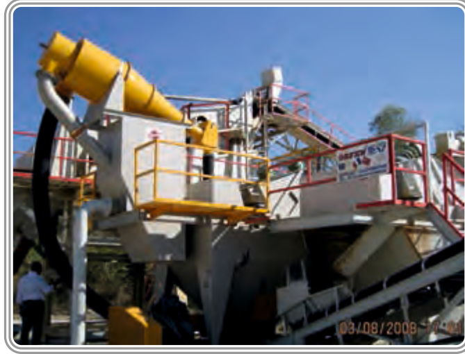
AKGÜN YAPI SAN. VE TİC. LTD. ŐTİ.Çorlu / TEKİRDAĞ 200 ton/saat KUM YIKAMA ve ELEME TESİSİ
