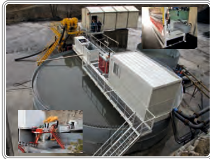
ETİ KROM "KROM KONSANTRE TESİSİ" ELAZIĞ 650 M 3 /saat TEMİZ SU GERİ DÖNÜŞÜM ÜNİTESİ 25 t/saat FİLTRE PRES ÜNİTESİ 50 t/saat KUM YIKAMA ve SUSUZLANDIRMA ÜNİTESİ
