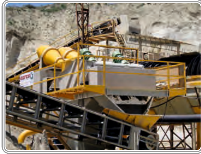
KOÇER MADENCİLİK İNŞAAT SAN. TİC. LTD. ŞTİ. Silivri / İSTANBUL 100 ton/saat KUM YIKAMA ve ELEME TESİSİ
