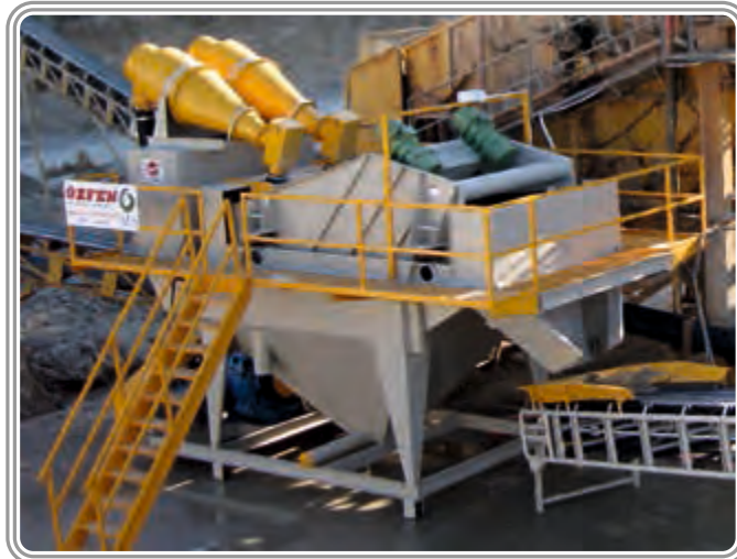
VİZELER MADENCİLİK YAPI SAN. TİC. LTD. ŞTİ. TEKİRDAĞ 150 Ton/saat SUSUZLANDIRMA ÜNİTESİ
