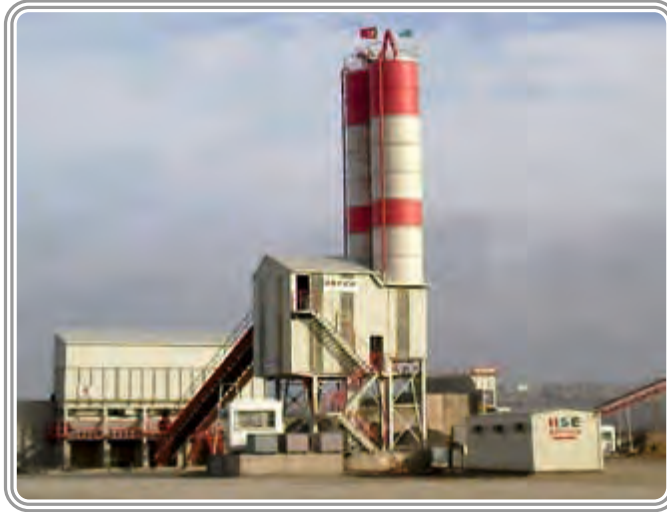
AGT "Azvirt" Azarbeycan Bakü 90 m 3 /saat Yaş Karışım Beton Santrali
