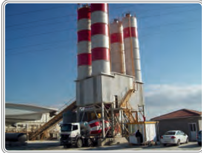
AYYILDIZ Hazır Beton Gelibolu / Çanakkale 90 m 3 /saat Yaş Karışım Hazır Beton Santrali
