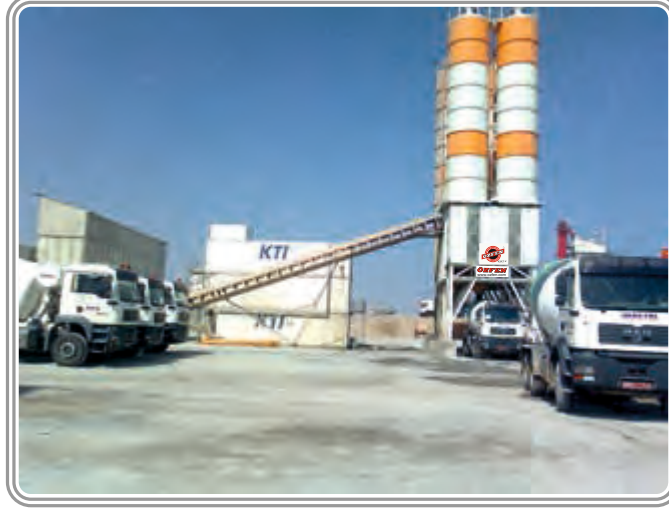
ONUR Taahhüt Taşımacılık ve Ticaret Limited şirketi Umman/ 90 m 3 /saat Yaş Karışım Hazır Beton Santrali
