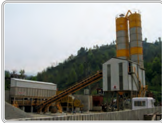
Doğaner Harfiyat San. Tic. Ltd. Şti. Rize / Güneysu Türkiye 90 m 3 /saat Yaş Karışım Beton Santrali
