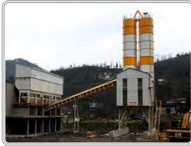
Yama-Ko İnşaat Malz. Paz. San. Ltd. Şti. Rize / Kalkandere Türkiye 90 m 3 /saat Yaş Karışım Beton Santrali
