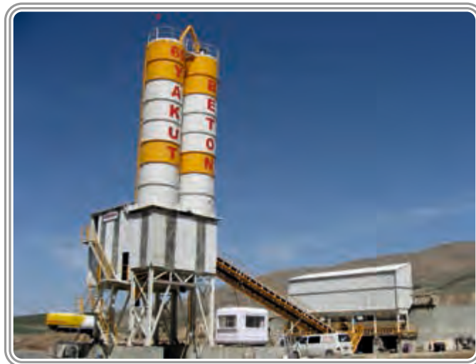
69 Yakut Beton Bayburt Türkiye 90 m 3 /saat Yaş Karışım Beton Santral
