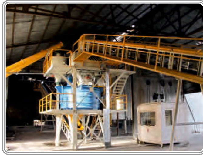
Eti Krom Maden işletmeleri "Yıldırım Holding" Türkiye 70 m 3 /saat Yaş karışım hazır beton santrali
