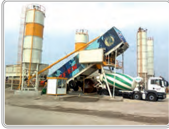
ONUR Taahhüt Taşımacılık ve Ticaret Limited Şirketi / MOLDOVYA 70 m 3 /saat Yaş Karışım Mobil Hazır Beton Santrali
