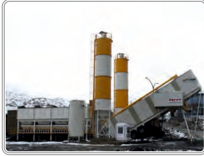
Eti Krom Maden İşletmeleri "Yıldırım Holding" Türkiye 70 m 3 /saat Yaş Karışım Mobil Hazır Beton Santrali
