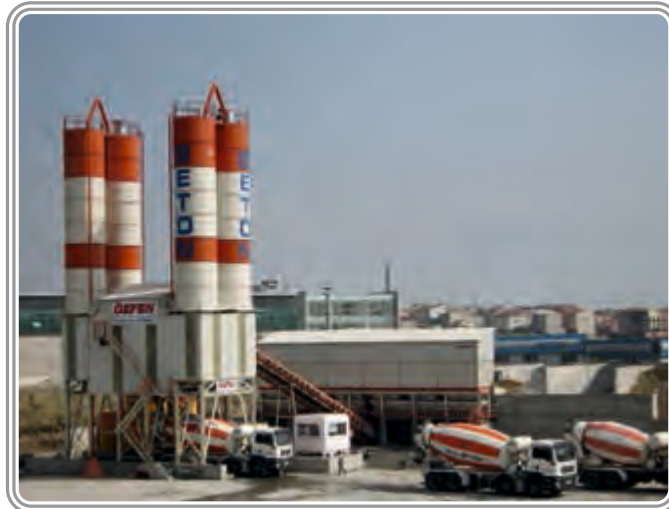
Ulu Beton İnş. Taah. San. Ltd. Şti. İstanbul Türkiye 120-130 m 3 /saat Yaş Karışım Beton Santrali
