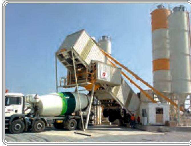
ONUR Taahhüt Taşımacılık ve Ticaret Limited şirketi Umman 70 m 3 /saat Yaş Karışım Mobil Hazır Beton Santrali
