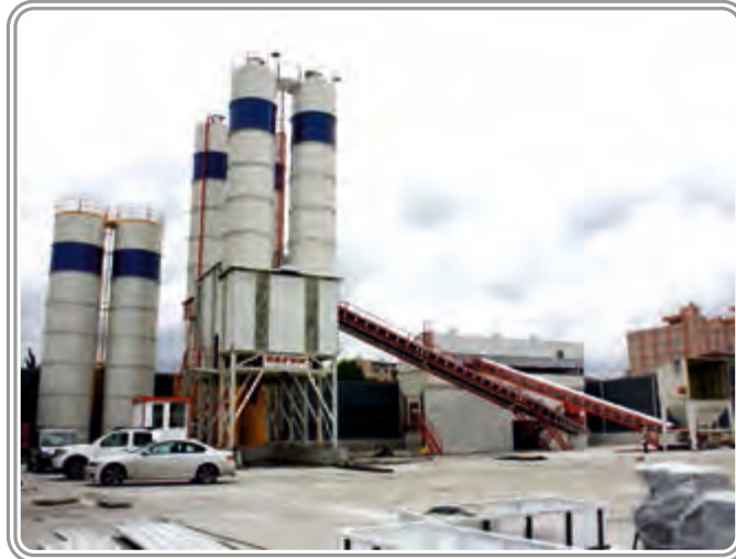
Nimsan / Akçansa / Samsun 120 m 3 /saat Yaş Karışım Hazır Beton Santrali
