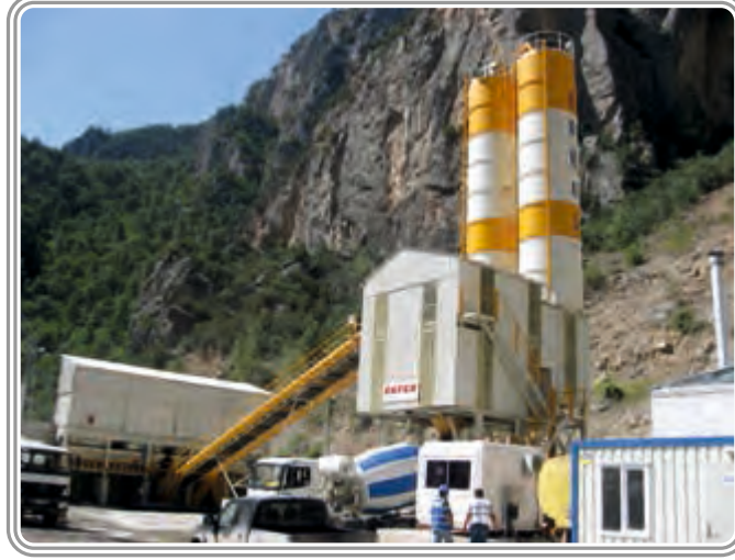
Doğuş İnşaat ve Ticaret A.Ş. Boyabat Barajı / Durağan Türkiye 90 m 3 /saat Yaş Karışım Beton Santrali
